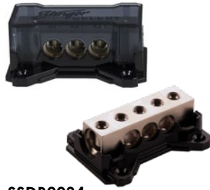
SSDB2034 Distribution Block · 100% Brass/Satin Finish · (2) 1/0GA Input · (3) 4GA Output
