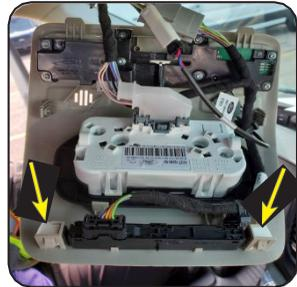
Si le véhicule est équipé du plateau de pavillon, le boîtier du plafonnier sera légèrement différent. Il peut être retiré de manière similaire.
