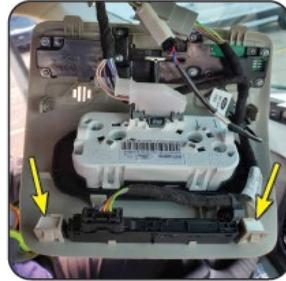
Si el vehículo está equipado con la bandeja superior, la carcasa de la luz de techo será ligeramente diferente. Puede retirarse de manera similar.
